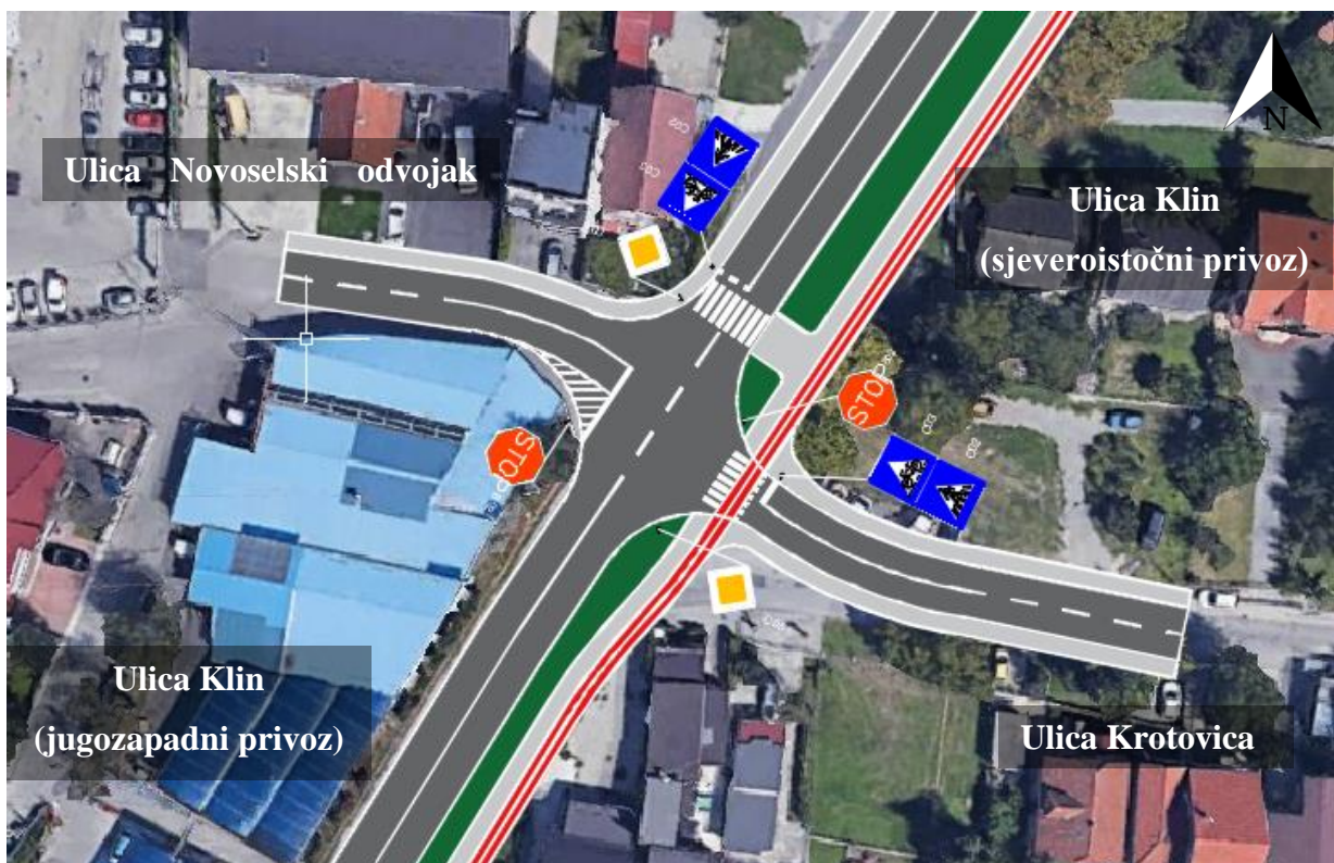
Slika 30. Idejno prometno rješenje raskrižja Ulica Klin, Krotovica i Novoselski odvojak X.
