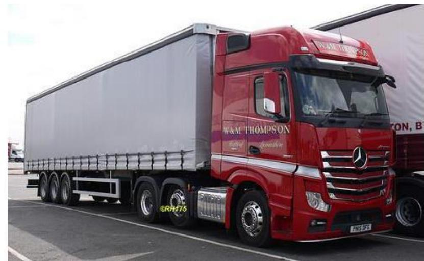
Slika 22. Tegljač s tri osovine i poluprikolica s tri osovine
