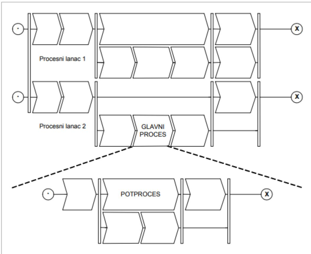
Slika 23. Prikaz procesnog lanca uz pomoć strukture potprocesa
