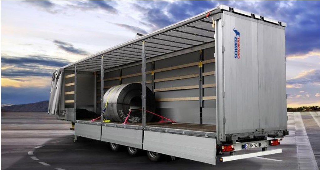
Slika 9.: Poluprikolica „mulda“ sa teretom [15]
