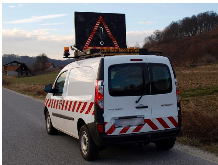
Slika 26: Prikaz označenog vozila jednostavne pratnje
