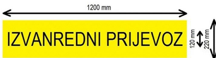
Slika 23: Dimenzije oznake izvanrednog prijevoza
