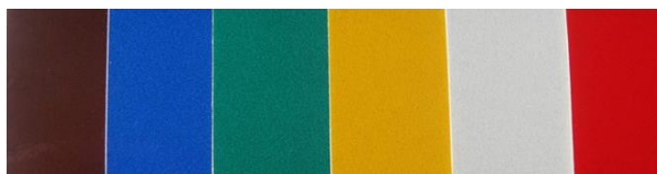
Slika 6: Retroreflektirajući materijali prve klase
