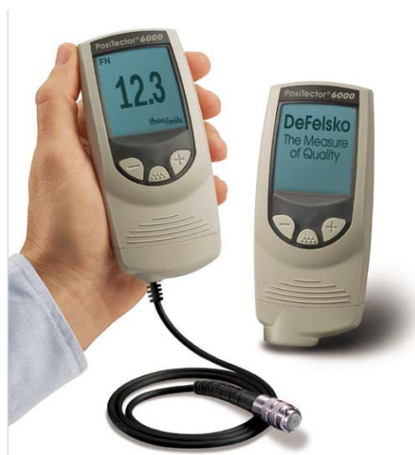
Slika 17. Uređaj za mjerenje debljine suhog filma oznake
