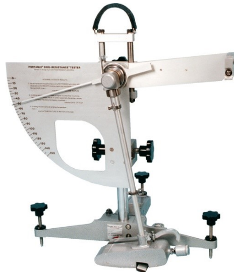
Slika 19. Klatni uređaj za ispitivanje otpornosti na klizanje
