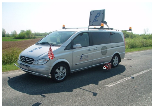
Slika 16. Mjerno vozilo s montiranim uređajem ZDR 6020
