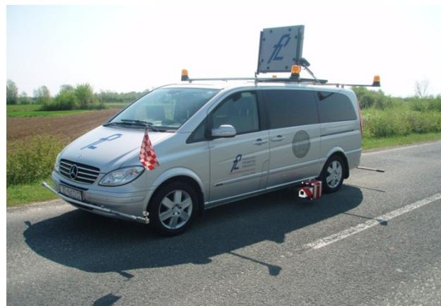
Slika 16. Mjerno vozilo s montiranim uređajem ZDR 6020
