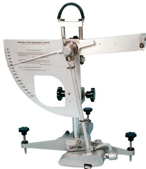
Slika 19. Klatni uređaj za ispitivanje otpornosti na klizanje
