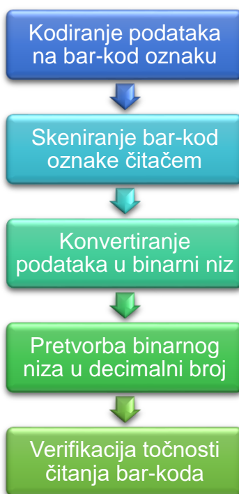
Slika 4. Osnovni princip rada bar-kodova
