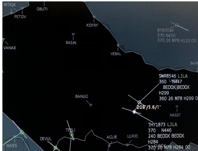
Slika 27 Uporaba QDM za očitavanje adekvatne horizontalne separacije
