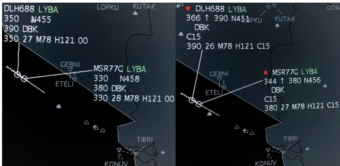
Slika 31 Prikaz prometne situacije gdje su dva zrakoplova razdvojena vertikalnim brzinama
