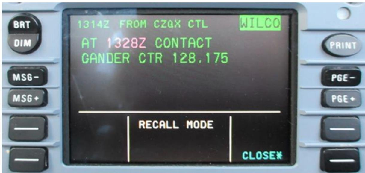
Slika 16 Prikaz pilotovog CPDLC ekrana
