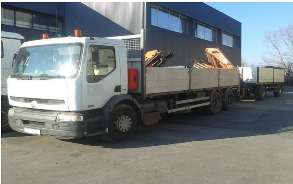
Slika 14. Renault 320.26 kamion s kranom Fassi 150A
