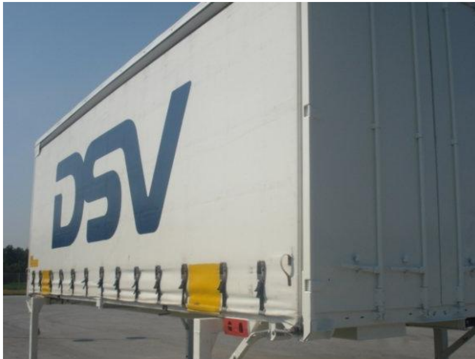
Slika 2. Izmjenjivi transportni sanduk na nauglicama
