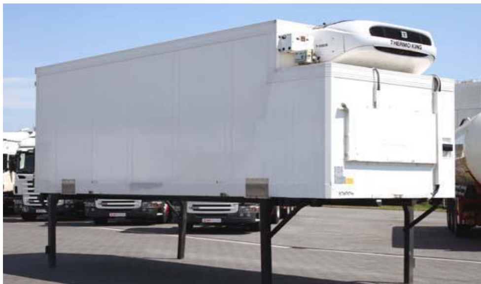
Slika 3. Izmjenjivi transportni sanduk sa klimom
