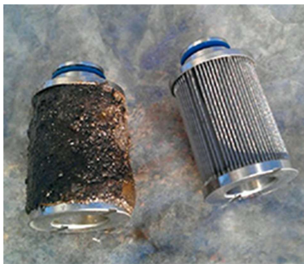
Slika 4: Prikaz onečišćenog pročišćivača. [1]
