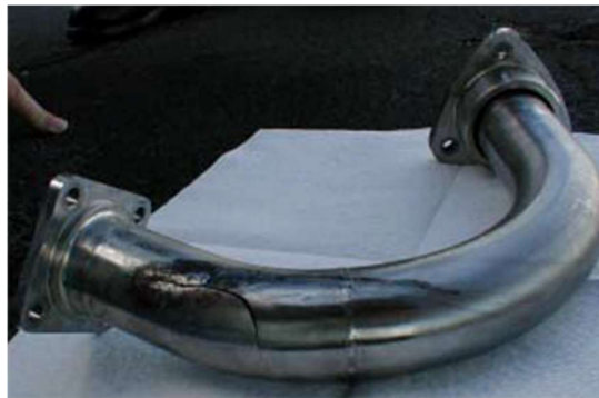
Slika 28: Puknuta gorivna cijev gorivnog sustava leta Air Transat Flight 236. [30]
