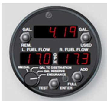
Slika 9: Indikator protoka goriva. [1]
