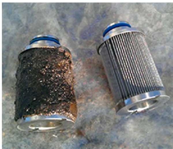
Slika 4: Prikaz onečišćenog pročišćivača. [1]
