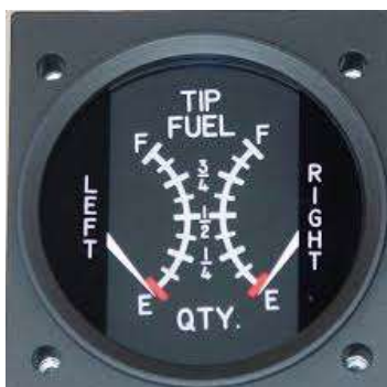
Slika 8: Indikator mase goriva. [1]
