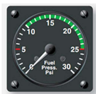
Slika 11: Indikator tlaka goriva. [1]
