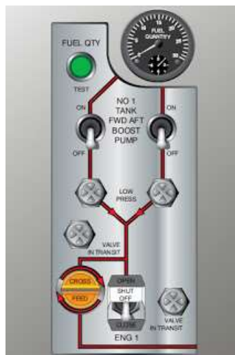
Slika 12: Indikator promijene ventila spremnika goriva. [1]
