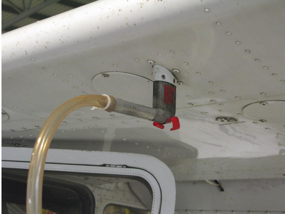
Slika 11. Pitot cijev pripremljena za ispitivanje
