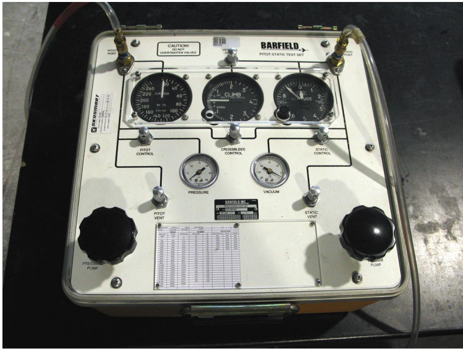
Slika 7. Ispitni uređaj „Barfield“, model 1811GA
