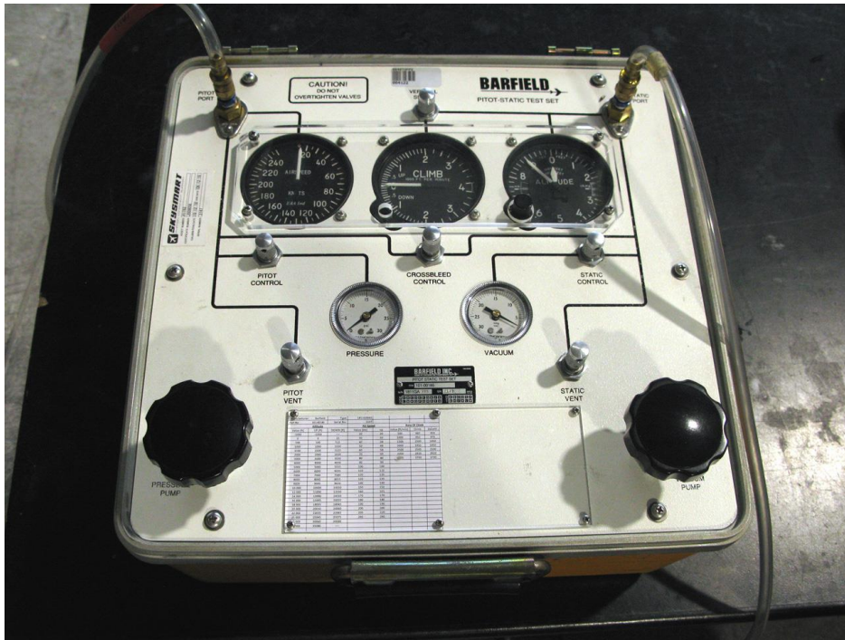
Slika 7. Ispitni uređaj „Barfield“, model 1811GA
