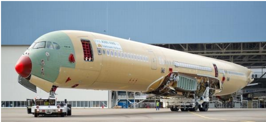
Slika 19. Kokpit od aluminija kod modela A350 [51]
