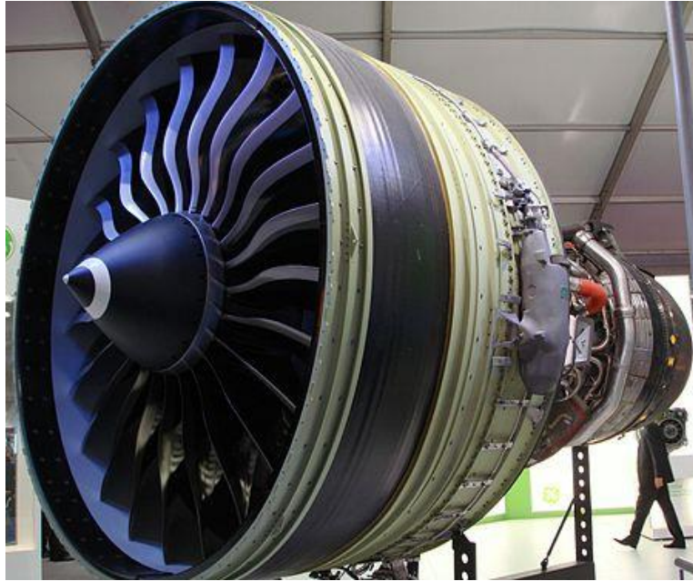
Slika 14. GE90 mlazni motor [42]
