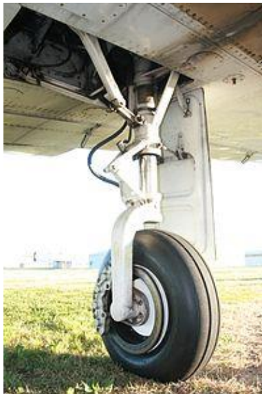
Slika 1. Čelik u konstrukciji stajnog trapa
