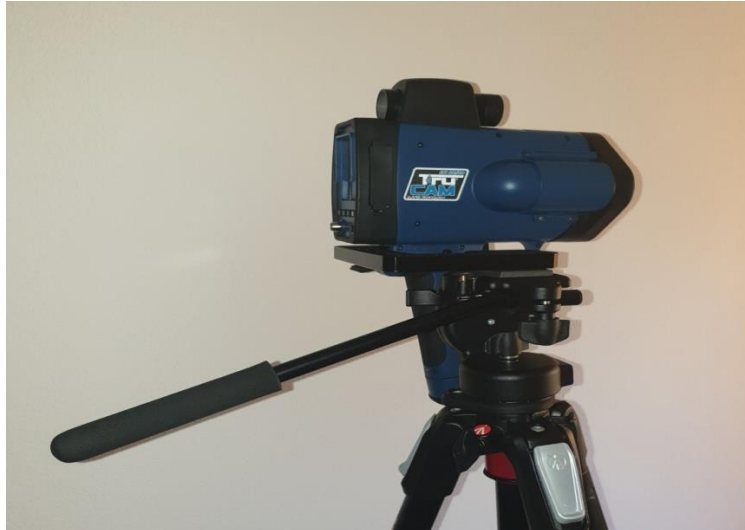
Slika 27. Uređaj za mjerenje brzine TruCAM Laser Speed Gun
