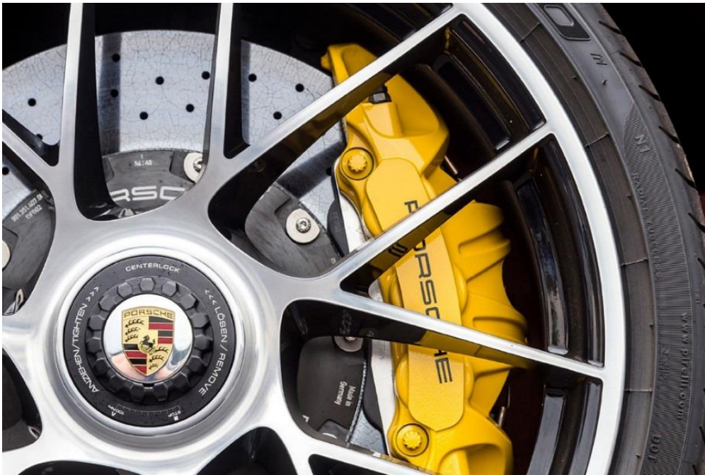
Slika 5: Keramički diskovi na automobilu Porsche Izvor: [8]
