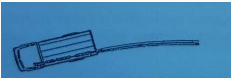
Slika 9: Tragovi blokirajućeg kotača Izvor: [9]
