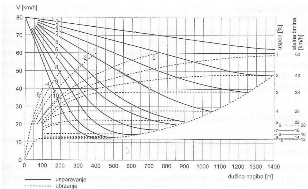
**Slika 2.1.** Odnos brzine sporoga vozila i duljine uzdužnog nagiba
