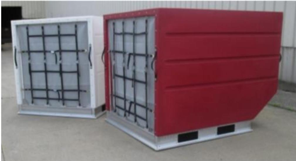
Slika 3. Primjer avionskih kontejnera
