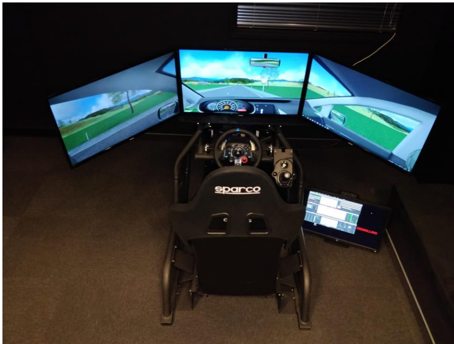
Slika 16. Prikaz simulatora vožnje korištenog u provedenom istraživanju
