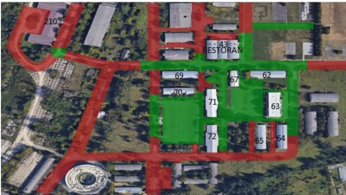
Slika 26. Prikaz područja prihvatljive i neprihvatljive snage primljenoga signala
