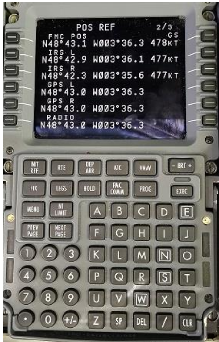
Slika 22. Proračunata pozicija zrakoplova
