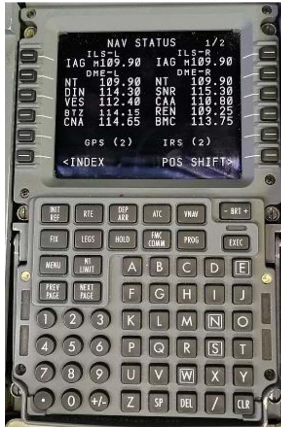
Slika 21. Prikaz radio-navigacijskih sredstava
