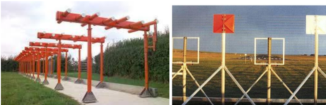
Slika 5. Primjer log-periodske antene i četvrtaste antene. [4]
