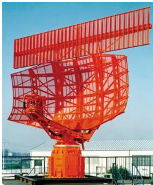
Slika 4. Zakrivljeni donji reflektor je primarni radar, dok je ravna antena na vrhu sekundarni radar
