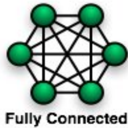
Slika 7. Isprepletana mrežna topologija [6]
