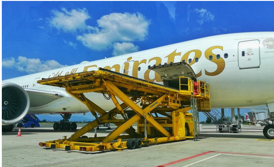
Slika 2 Cargo high loader - slozeno manipulativno sredstvo
