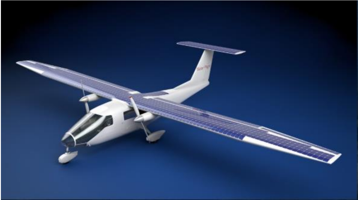
Slika 7. Prikaz solarno-električnog šes zrakoplova sa šest sjedala
