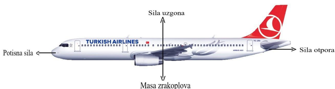
Slika 1. Prikaz sila u horizontalnom ustaljenom letu
