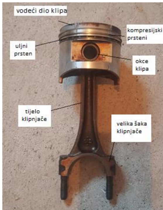
Slika 9. Sastavni dijelovi klipa s klipnjačom
