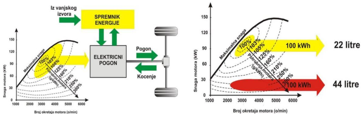
Slika 23.: Međuovisnost snage, broja okretaja, opterećenja i potrošnje motora: a) električnih vozila; i b) konvencionalnih vozila
