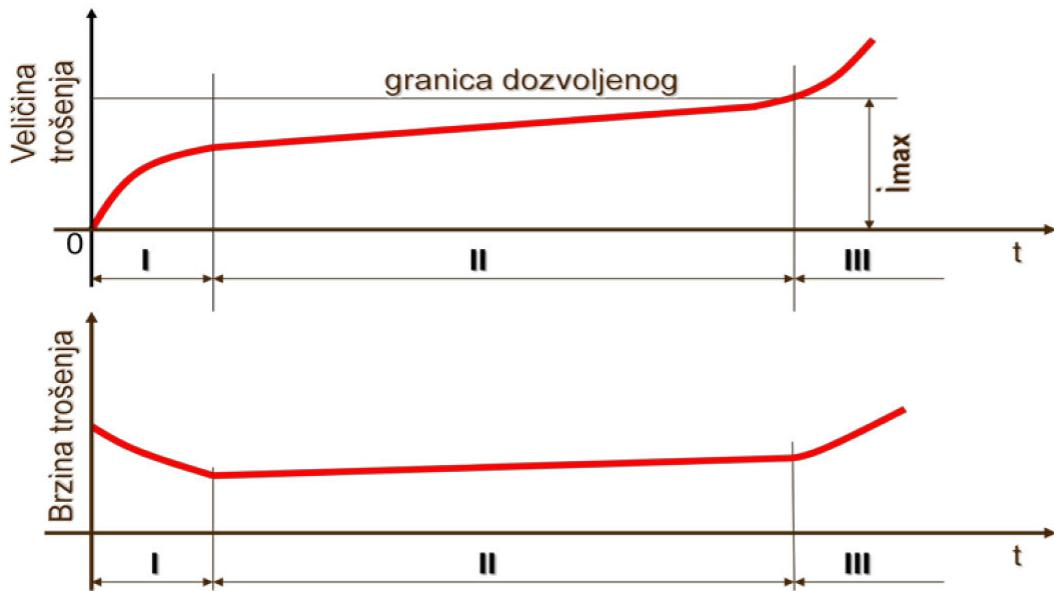
Slika 12.: Prikaz veličine i brzine trošenja elemenata tijekom vremena uporabe (eksplotacije)
