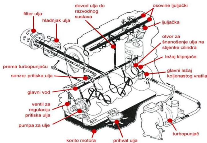
Slika 6.: Prikaz glavnih dijelova motora s unutarnjim izgaranjem
