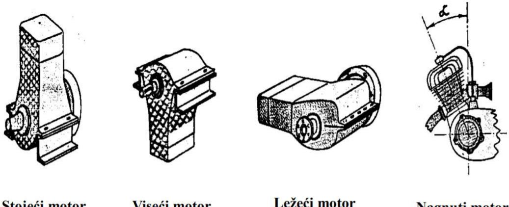
Slika 5.: Prikaz podjele motora s unutarnjim izgaranjem prema položaju cilindra
