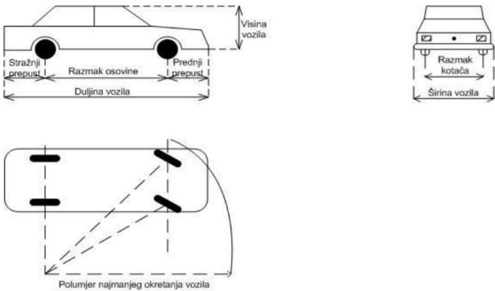
Slika 14.: Neke od osnovnih tehničkih značajki cestovnih motornih vozila
