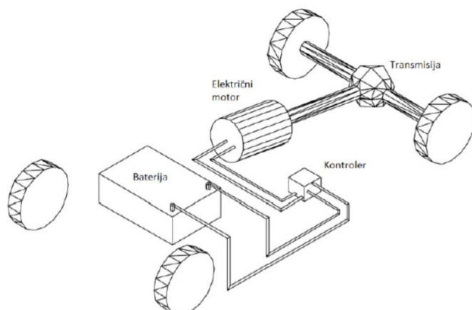
Slika 15.: Shema motornog vozila na električni pogon
