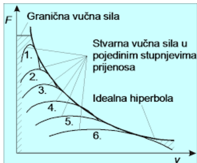
Slika 7: Grafički prikaz vučne sile i brzine vozila sa 6 stupnjeva prijenosa
