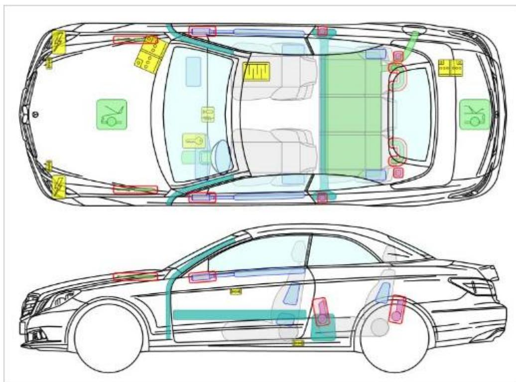
**Slika 9:** Prikaz elektronike zračnih jastuka 2012 Mercedes-Benz E-Class
