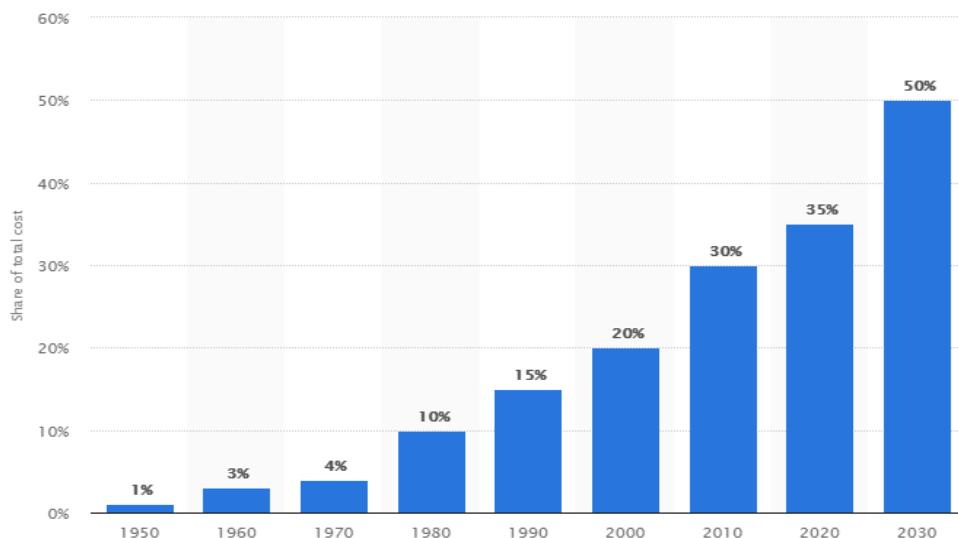
**Slika 1:** Postotak vrijednosti elektronike u vozilu od 1950. do 2030. godine
