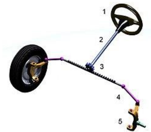
Slika 3. Zupčasti prijenos upravljačkog mehanizma
