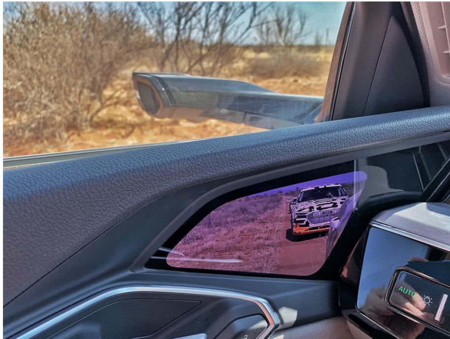
Slika 9. Kamera u funkciji retrovizora u Audi E-tronu
