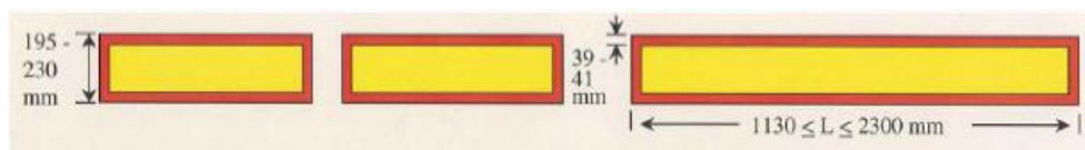
Slika 14. b) Retroreflektirajuća oznaka za teška teretna vozila Izvor: Nastavni materijal kolegija Vizualne informacije u prometu (30.6.2019)
