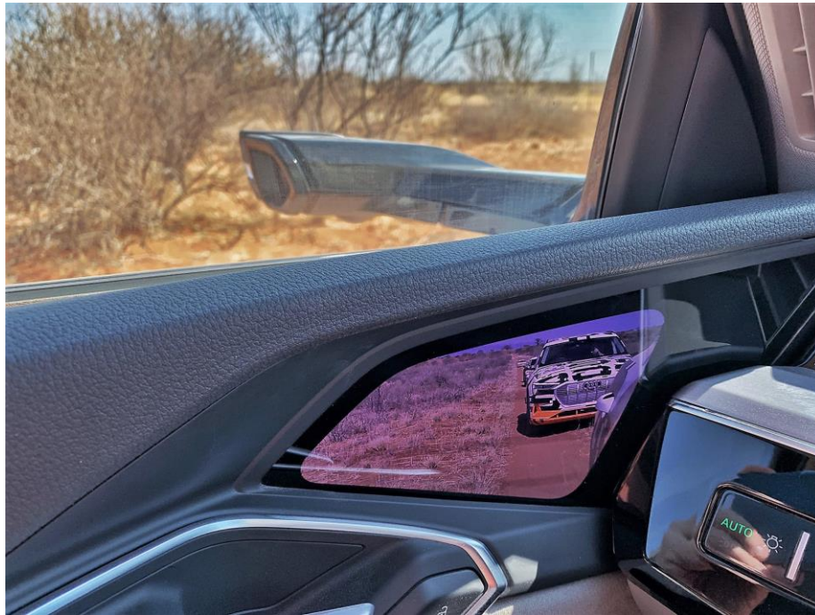
Slika 9. Kamera u funkciji retrovizora u Audi E-tronu
