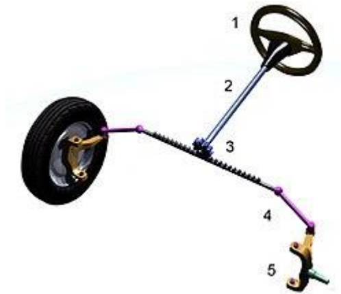
Slika 3. Zupčasti prijenos upravljačkog mehanizma
