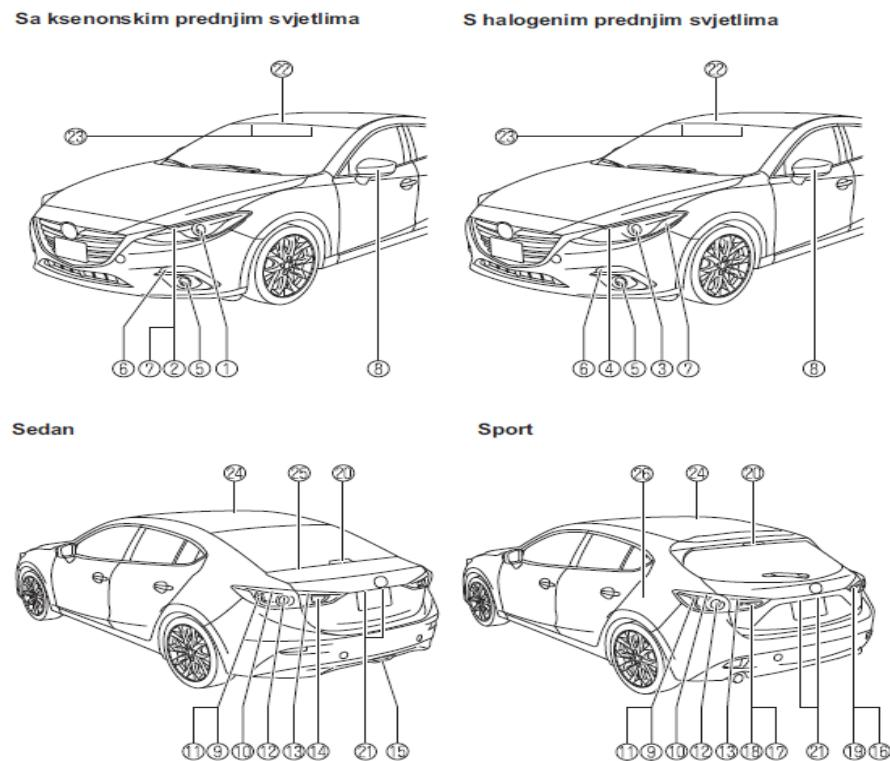
Slika 12. a) Pozicija svjetlosnih uređaja na automobilu Mazda 3
