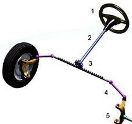
Slika 3. Zupčasti prijenos upravljačkog mehanizma
