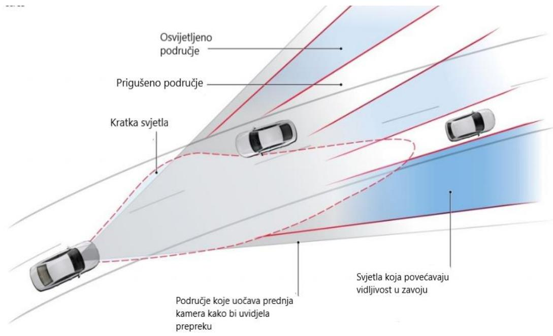
Slika 19. Princip rada LED Matrix tehnologije svjetala
