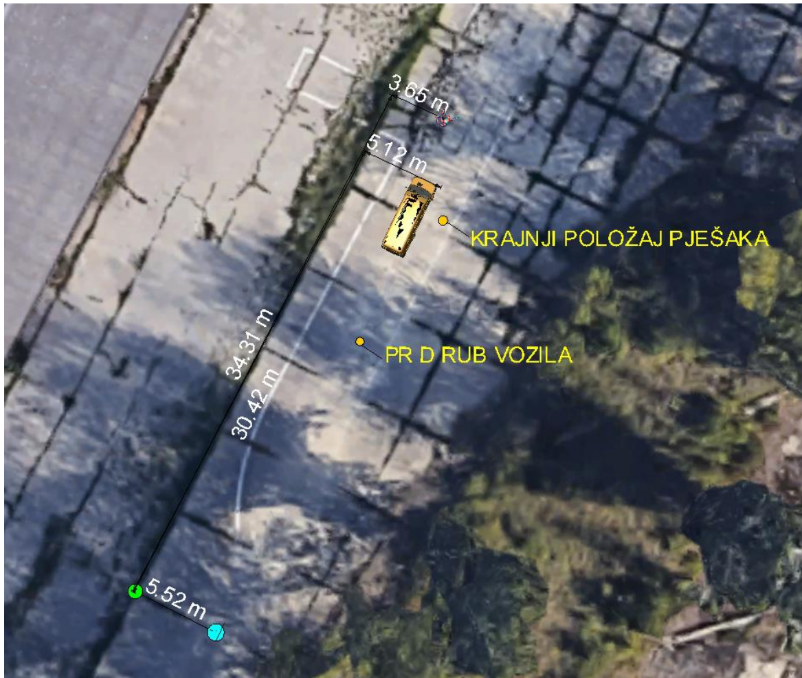
Slika 29. Simulacija naleta dostavnog vozila Renault Trafic na lutku pri brzini 67.3 km/h
