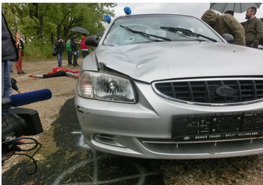
Slika 20. Prikaz oštećenja na vozilu uzrokovanih naletom na lutku II
