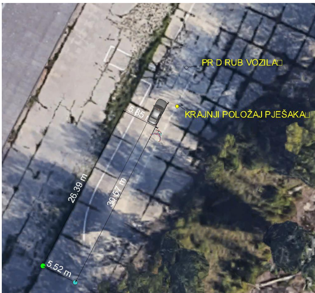
Slika 31. Simulacija naleta osobnog vozila Hyundai Accent na lutku I pri brzini 58,07 km/h
