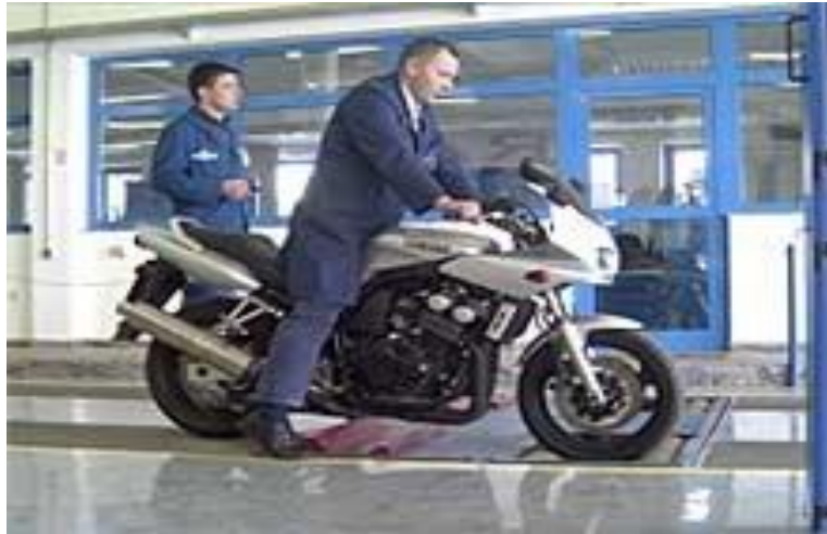
Slika 10. Mjerenje kočne sile na valjcima[8]
