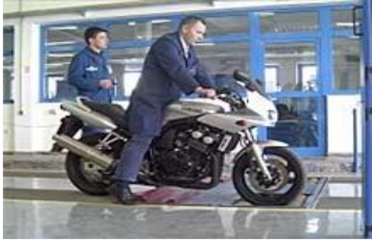
Slika 10. Mjerenje kočne sile na valjcima[8]
