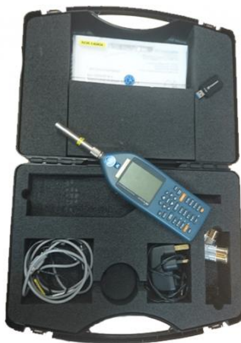
Slika 13. Zvukomjer Norsonic Nor140
