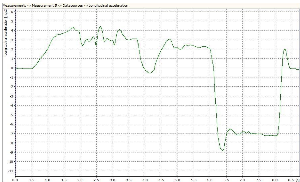
Grafikon 12. Prikaz longitudinalnog (x) ubrzanja/usporenja s obzirom na vrijeme vožnje (t) pri brzini od 50,32 km/h na suhom asfaltu
