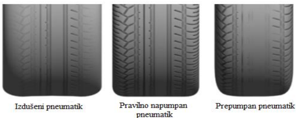
Slika 28. Prikaz kako trošenje pneumatika ovisi o tlaku zraka njima Izvor: [8]
