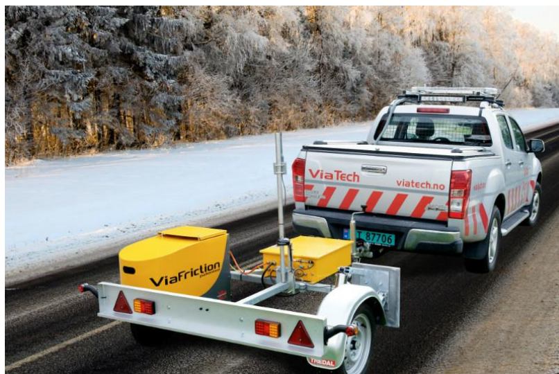
Slika 21. ViaFriction uređaj za zimske uvjete mjerenja Izvor: [15]
