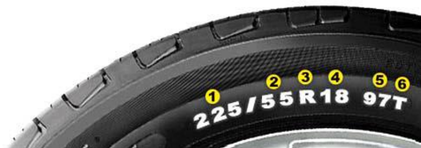
Slika 6. Prikaz osnovnih podataka o automobilskom pneumatiku Izvor: [6]
