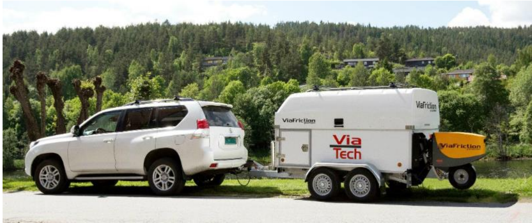
Slika 23. ViaFriction uređaj za ljetne uvjete mjerenja Izvor: [15]
