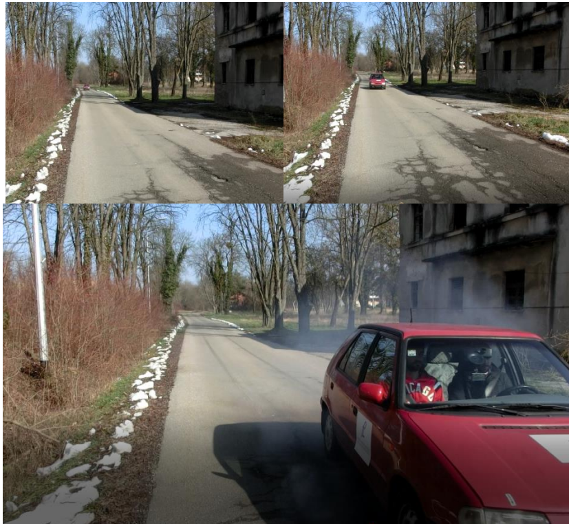
Slika 38. Prikaz kočenja na suhoj podlozi pri brzini od oko 80 km/h
