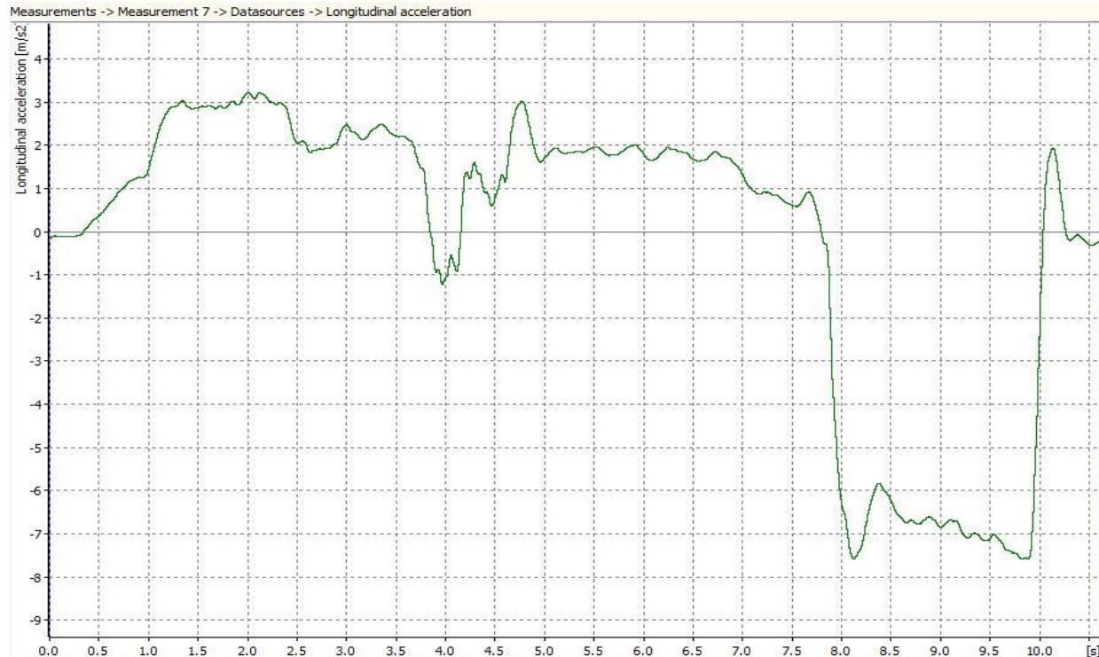
Grafikon 16. Prikaz longitudinalnog (x) ubrzanja/usporjenja s obzirom na vrijeme vožnje (t) pri brzini od  $48,60 \text{ km/h}$  na mokrom asfaltu
