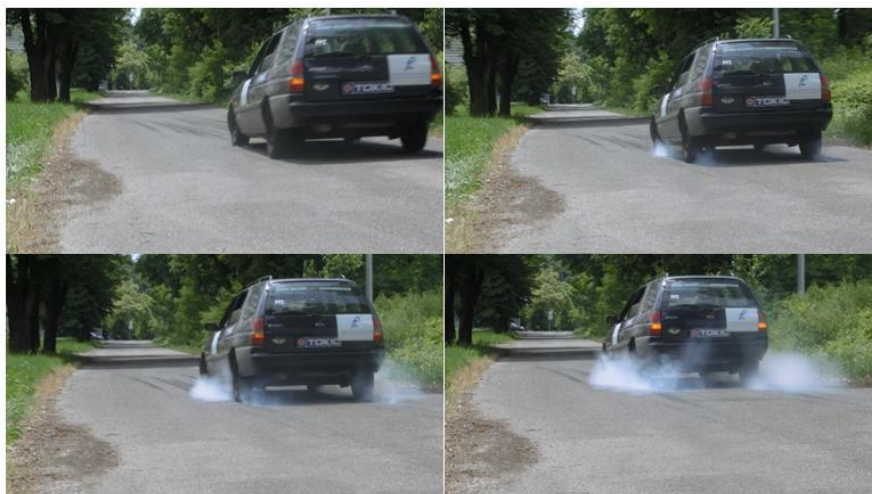
Slika 47. Prikaz kočenja testnim vozilom s isključenim ABS-om Izvor:[26]
