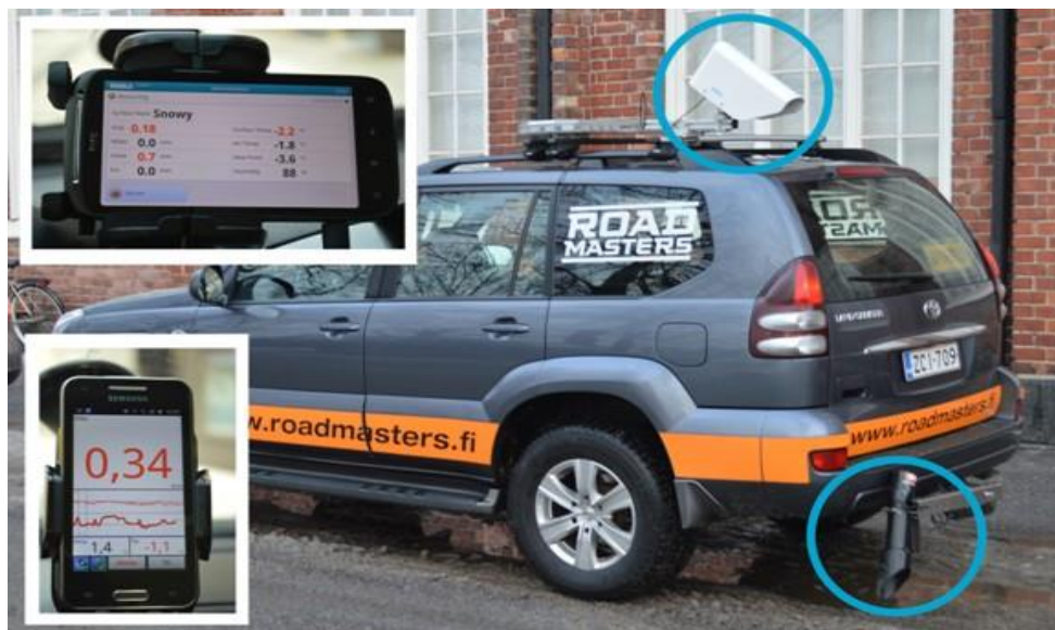
Slika 26. DSP310 terenski optički uređaj (gore) i optički terenski uređaj RCM411 (dolje) Izvor: [18]
