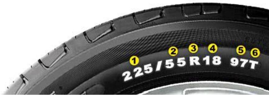
*Slika 6. Prikaz osnovnih podataka o automobilskom pneumatiku
