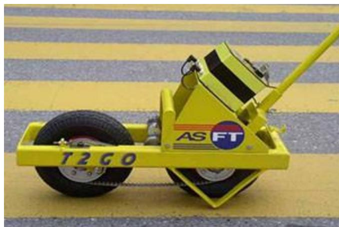
Slika 25. ASFT T2GO mjerni uređaj
