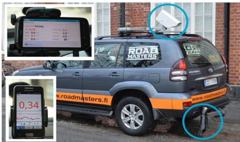
Slika 26. DSP310 terenski optički uređaj (gore) i optički terenski uređaj RCM411 (dolje)
