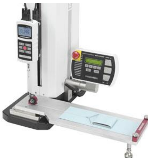
Slika 18. G1086 COF uređaj Izvor: [12]
