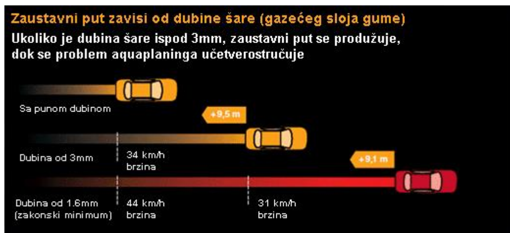
Grafikon 9. Zavisnost zaustavnog puta o dubini kanala gazećeg sloja pneumatika, izvor: [19]
