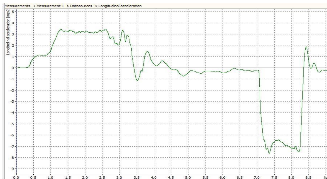
Grafikon 14. Prikaz longitudinalnog (x) ubrzanja/usporenja s obzirom na vrijeme vožnje (t) pri brzini od 30,14 km/h na mokrom asfaltu
