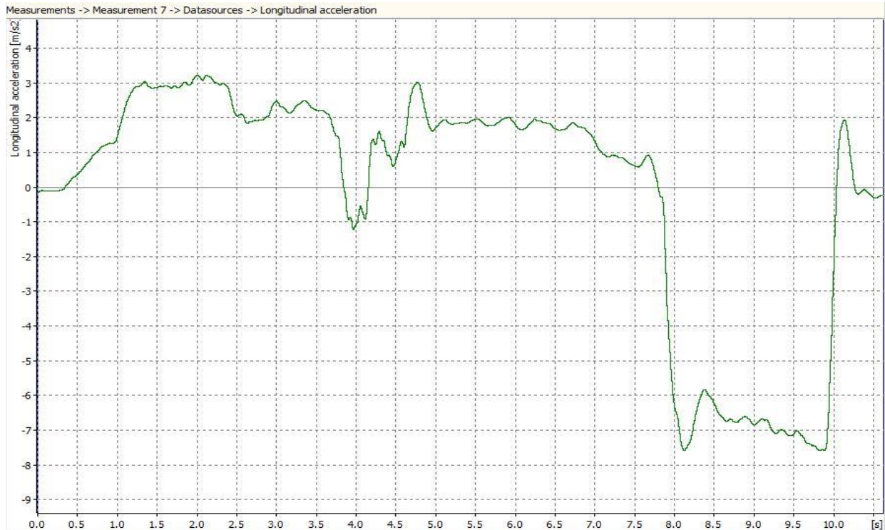
Grafikon 16. Prikaz longitudinalnog (x) ubrzanja/usporenja s obzirom na vrijeme vožnje (t) pri brzini od 48,60 km/h na mokrom asfaltu
