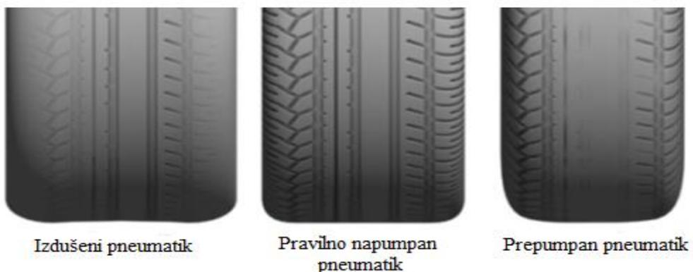
*Slika 28. Prikaz kako trošenje pneumatika ovisi o tlaku zraka njima*
