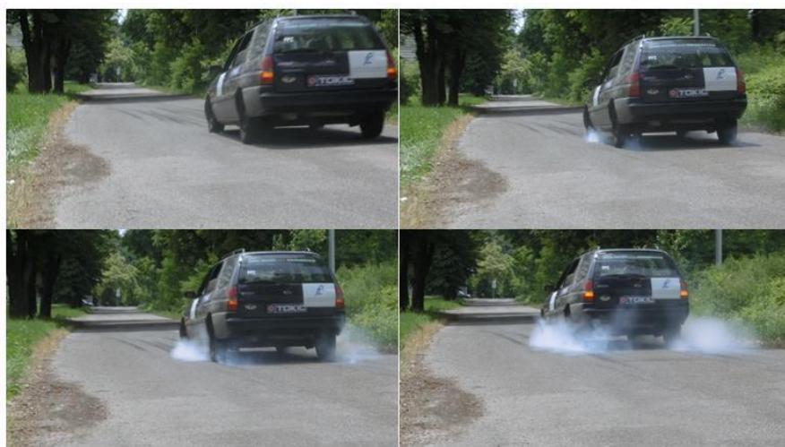
Slika 47. Prikaz kočenja testnim vozilom s isključenim ABS-om
