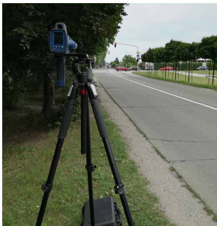
Slika 7.44: Snimanje (mjerenje) brzine na lokaciji 1
