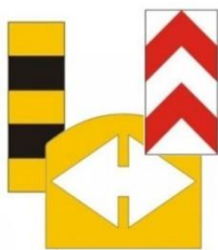
Slika 4.31: Oprema za označivanje vrha prometnog otoka Izvor: [24]
