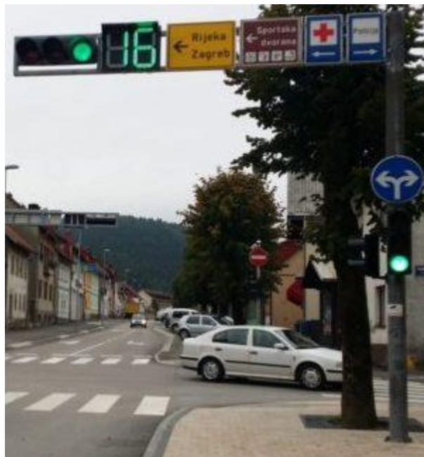
Slika 6.41: Brojač vremena na semaforskom uređaju Izvor: [26]
