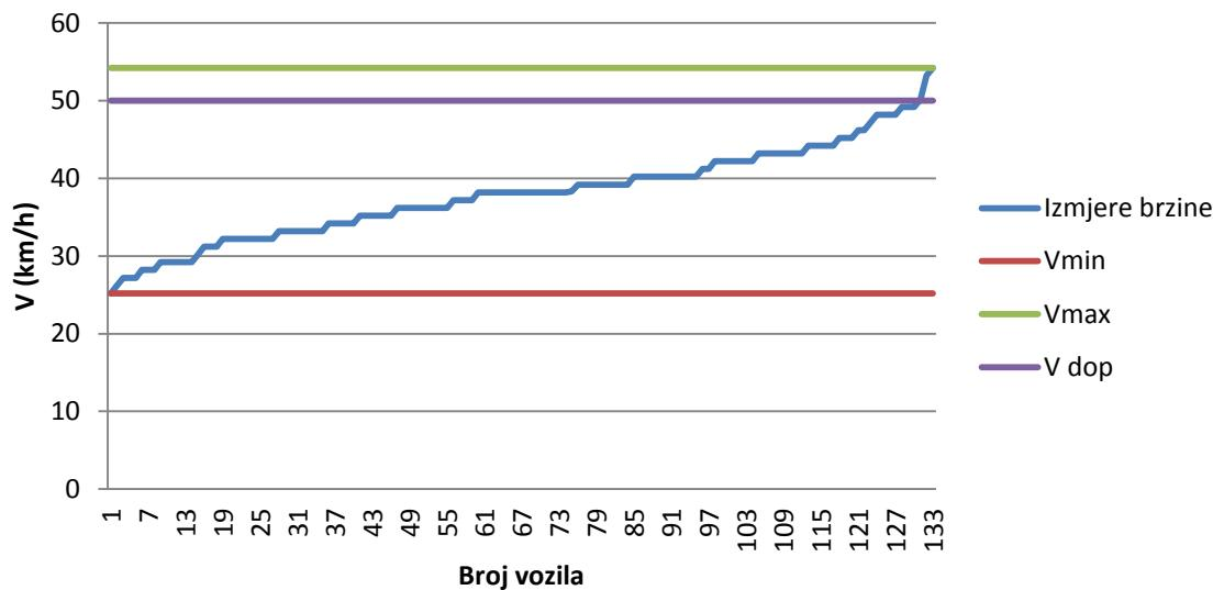
Grafikon 4: Grafički prikaz minimalne, maksimalne i dopuštene brzine na raskrižju s postavljenim brojačem vremena na semaforu
