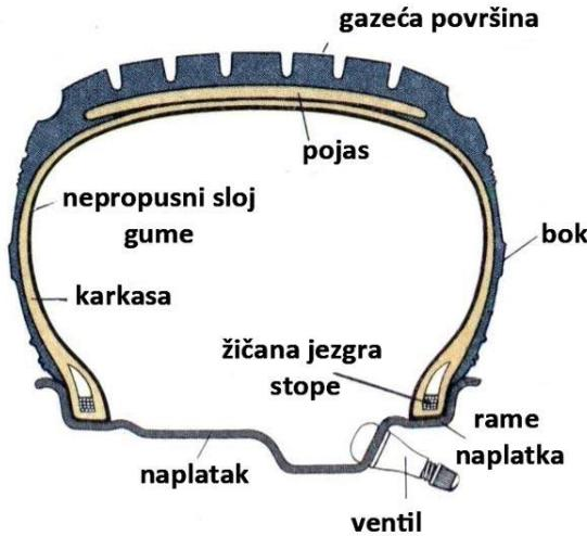
Slika 2.4: Poprečni presjek radijalnog pneumatika
