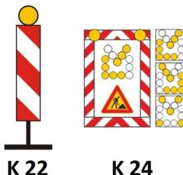
Slika 4.30: Svjetlosni znakovi za označavanje radova na cesti i zapreka
