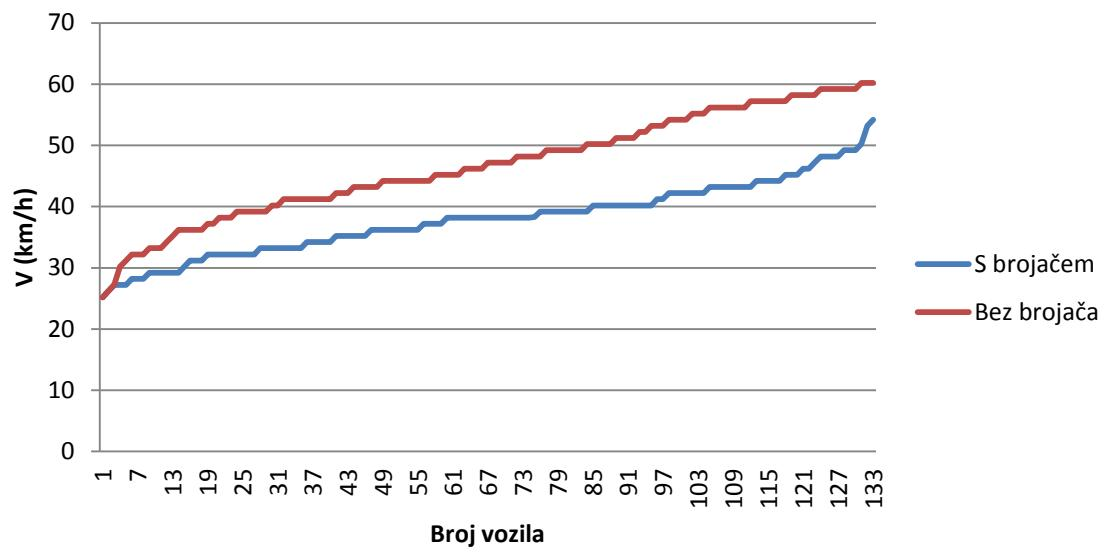
Grafikon 7: Prikaz komparacije izmjerenih brzina s brojačem i bez brojača vremena na semaforskim uređajima
