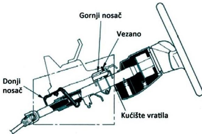
Slika 2.3: Upravljački mehanizam
