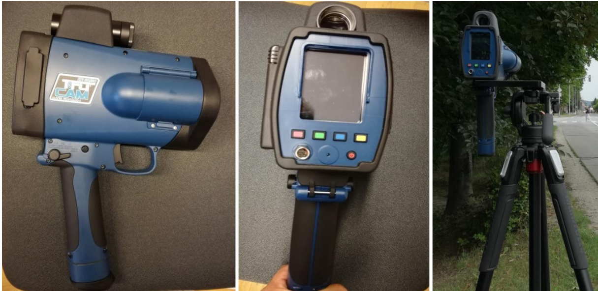
Slika 7.46: Uređaj za mjerenje brzine
