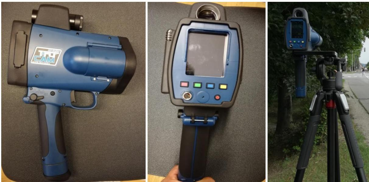
Slika 7.46: Uređaj za mjerjenje brzine
