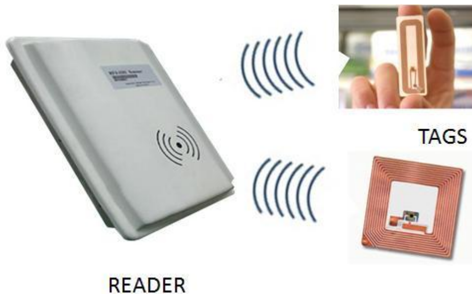
Slika 1. Princip rada RFID tehnologije [22]
