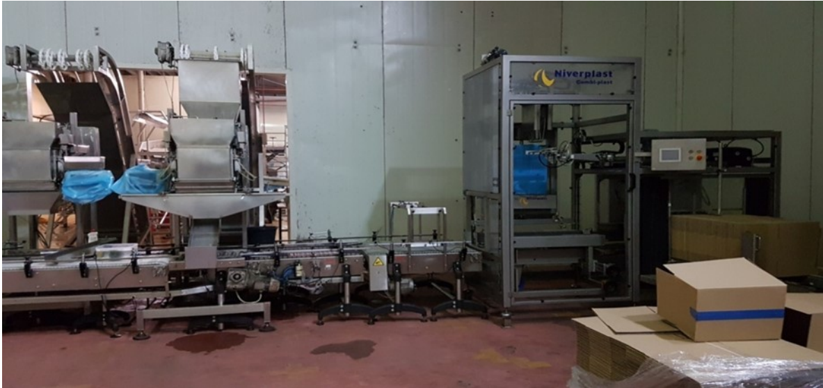
Slika 54 Stroj za formiranje kutija u odjelu pakiranja
