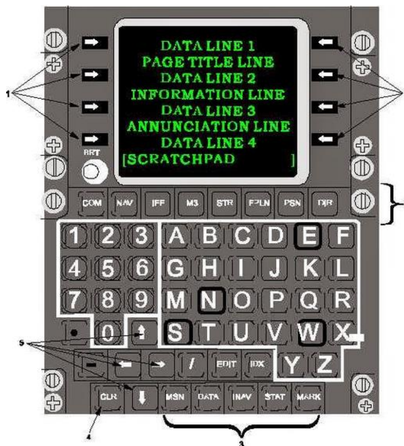
Slika 11: Kontrolna zaslonka jedinica CDU, [9]
