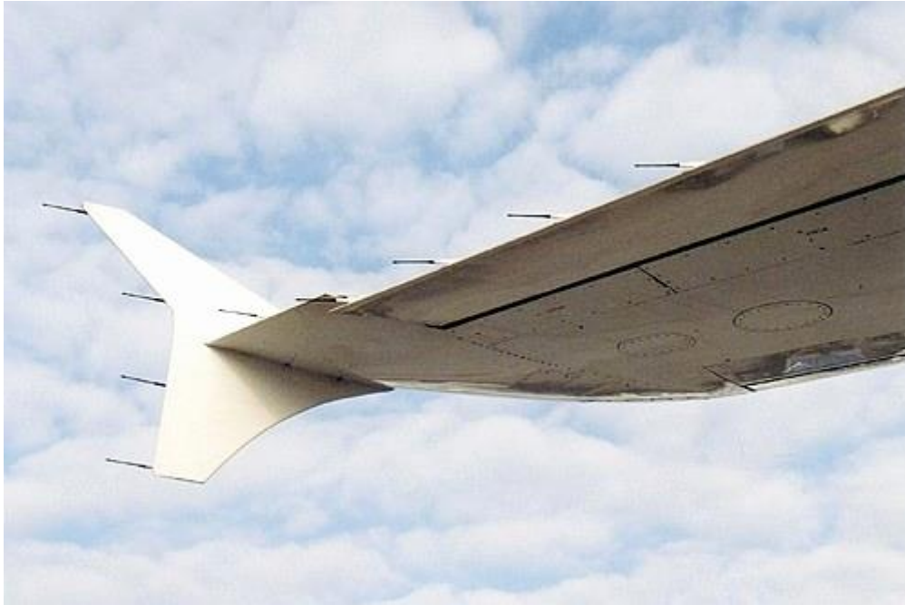
Slika 7. Statičko pražnjenje na primjeru zrakoplova A320, [19]
