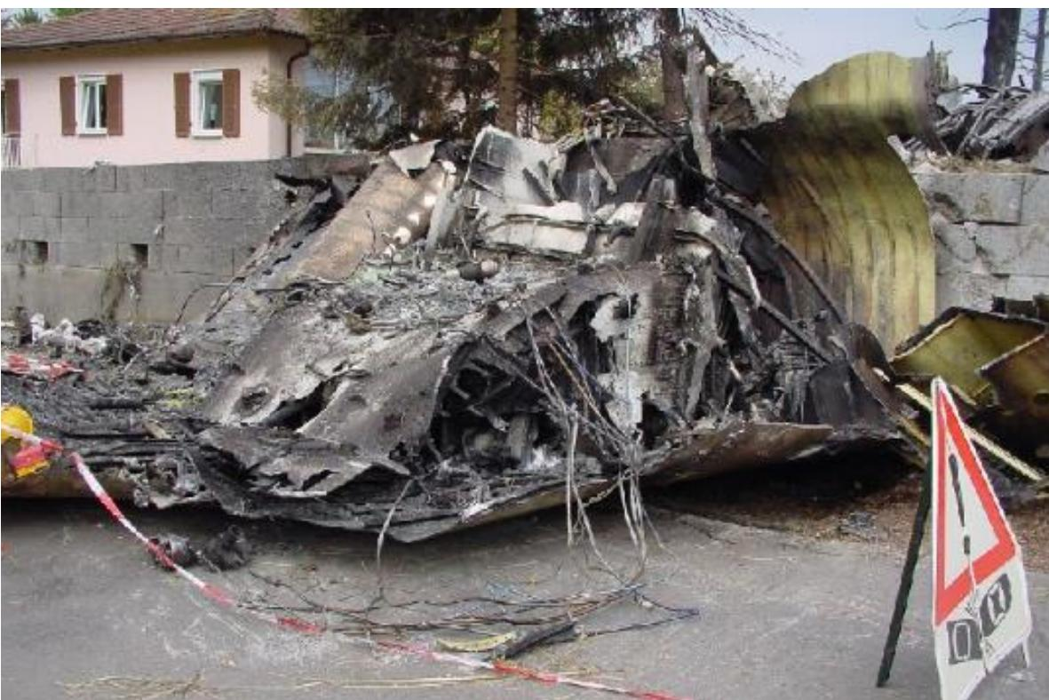
**Slika 18.** Središnji presjek krila zrakoplova, [15]
