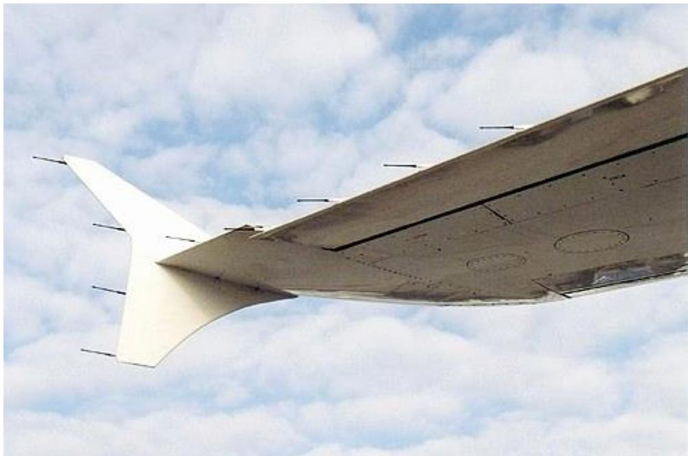
**Slika 7.** Statičko pražnjenje na primjeru zrakoplova A320, [19]
