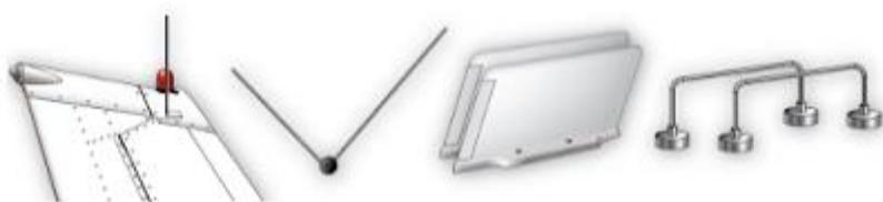
Slika 8: VOR antena na zrakoplovu, [9]
