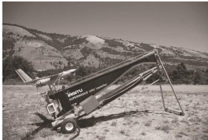
Slika 9. Sustav lansiranja drona putem katapulta
