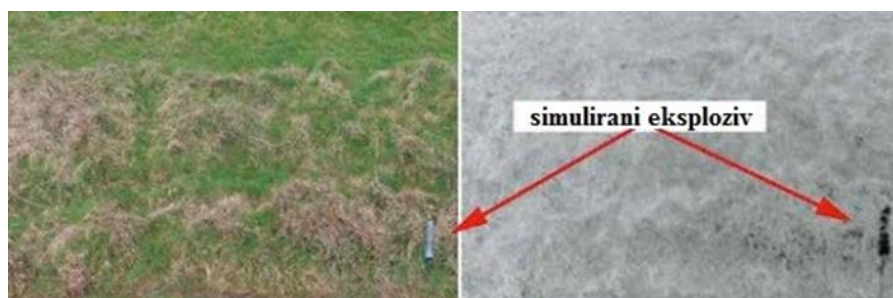
Slika 43. Razlika između fotografija slikanih sa i bez infracrvenog filtera
