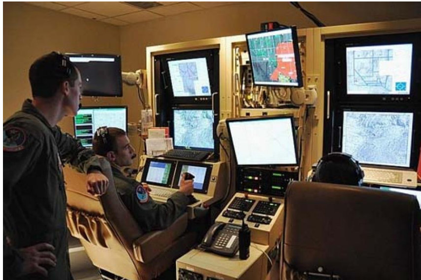
Slika 11. Američka zemaljska stanica sustava bespilotnih letjelica
