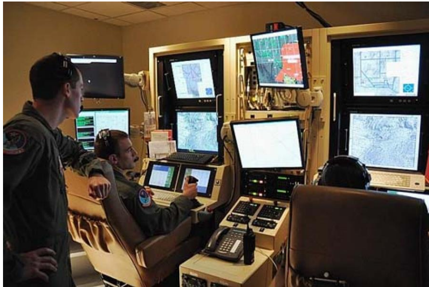
Slika 11. Američka zemaljska stanica sustava bespilotnih letjelica
