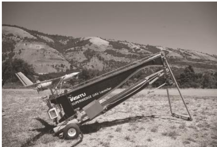
Slika 9. Sustav lansiranja drona putem katapulta
