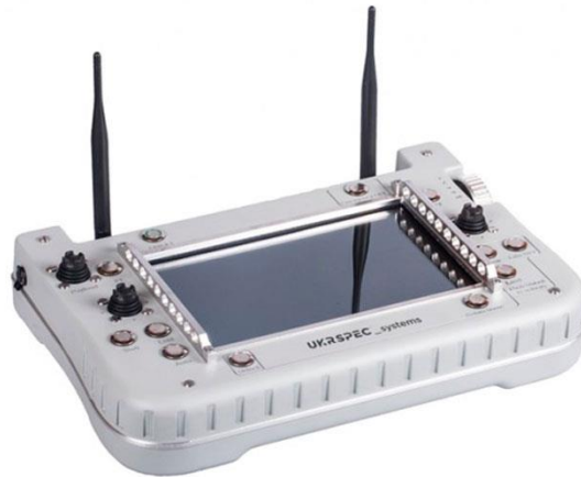
Slika 12. Ručni odašiljač tj. zemaljska stanica sustava bespilotnih letjelica
