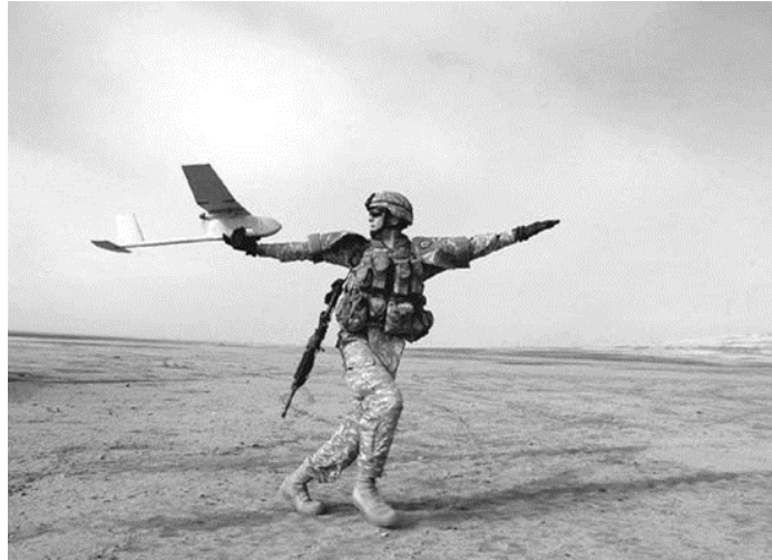
Slika 8. Dron "Raven RQ-11" lansiran iz ruku vojnika
