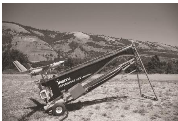
Slika 9. Sustav lansiranja drona putem katapulta
