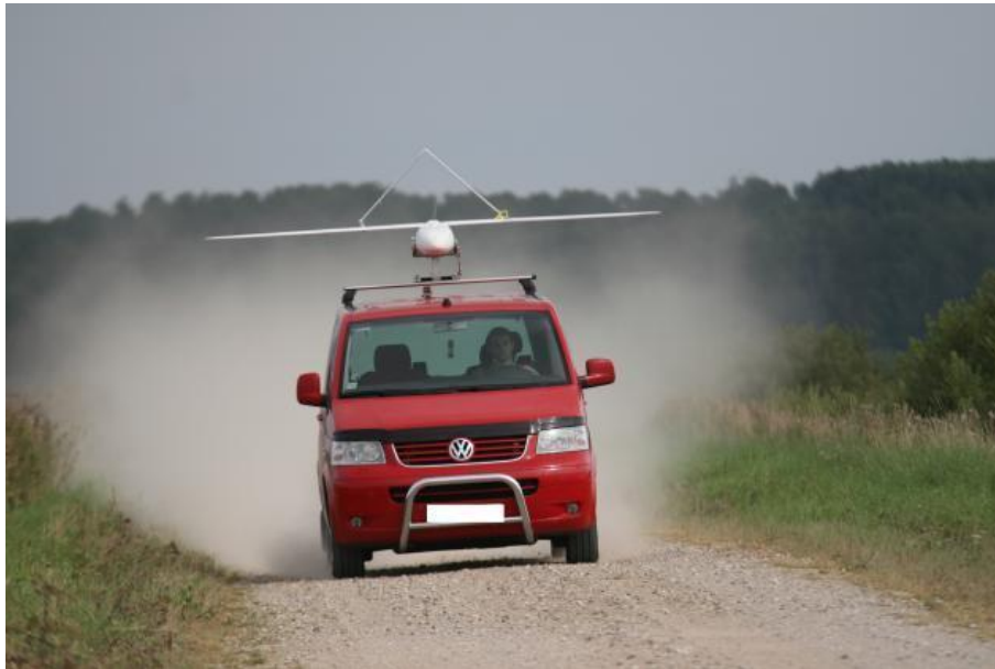
Slika 7. Primjer katapulta na automobilu
