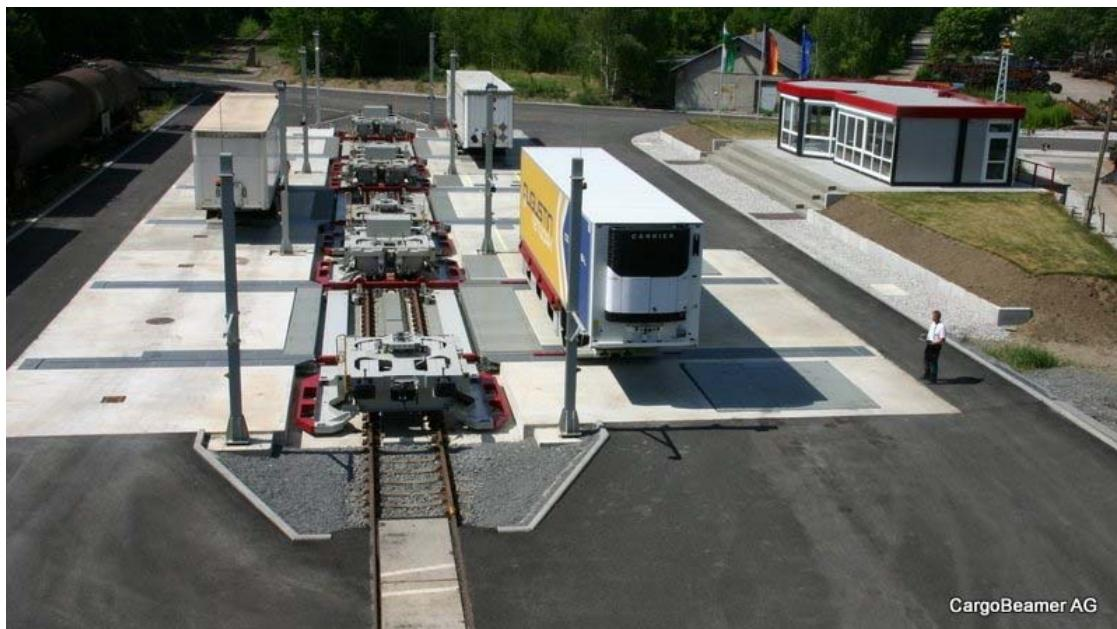
**Slika 19. Prikaz CargoBeamer paralelnog utovara i istovara**
