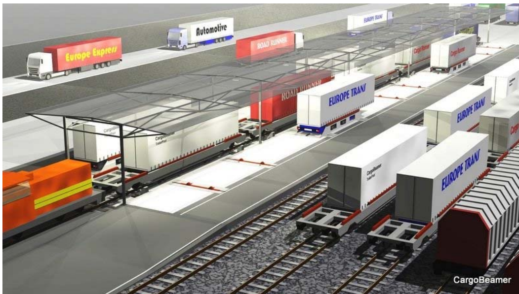
Slika 20. CargoBeamer s pet pretovarnih modula
