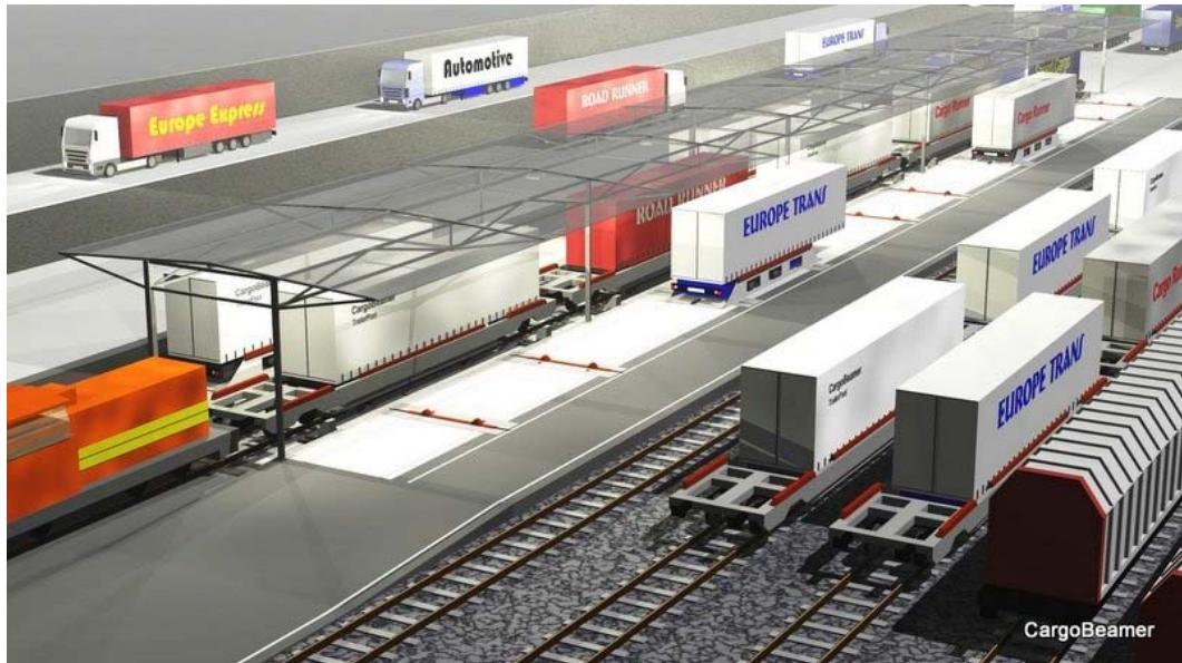
**Slika 20. CargoBeamer s pet pretovarnih modula**
