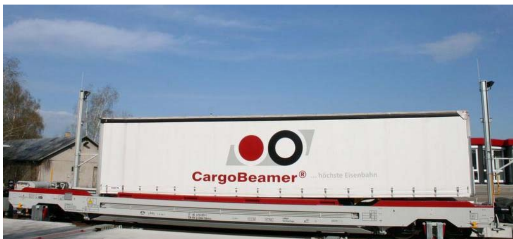
Slika 23. Poluprikolica na vagonu Izvor: https://www.cargobeamer.eu/Wagon-849772.html (03. 09. 2019.)
