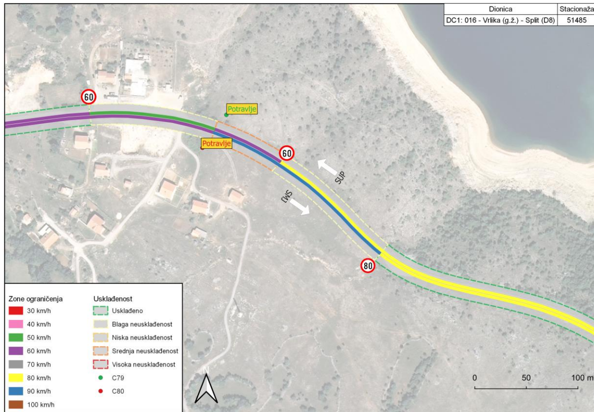
Slika 3. Primjer neusklađenih ograničenja brzine - lokacija 3
