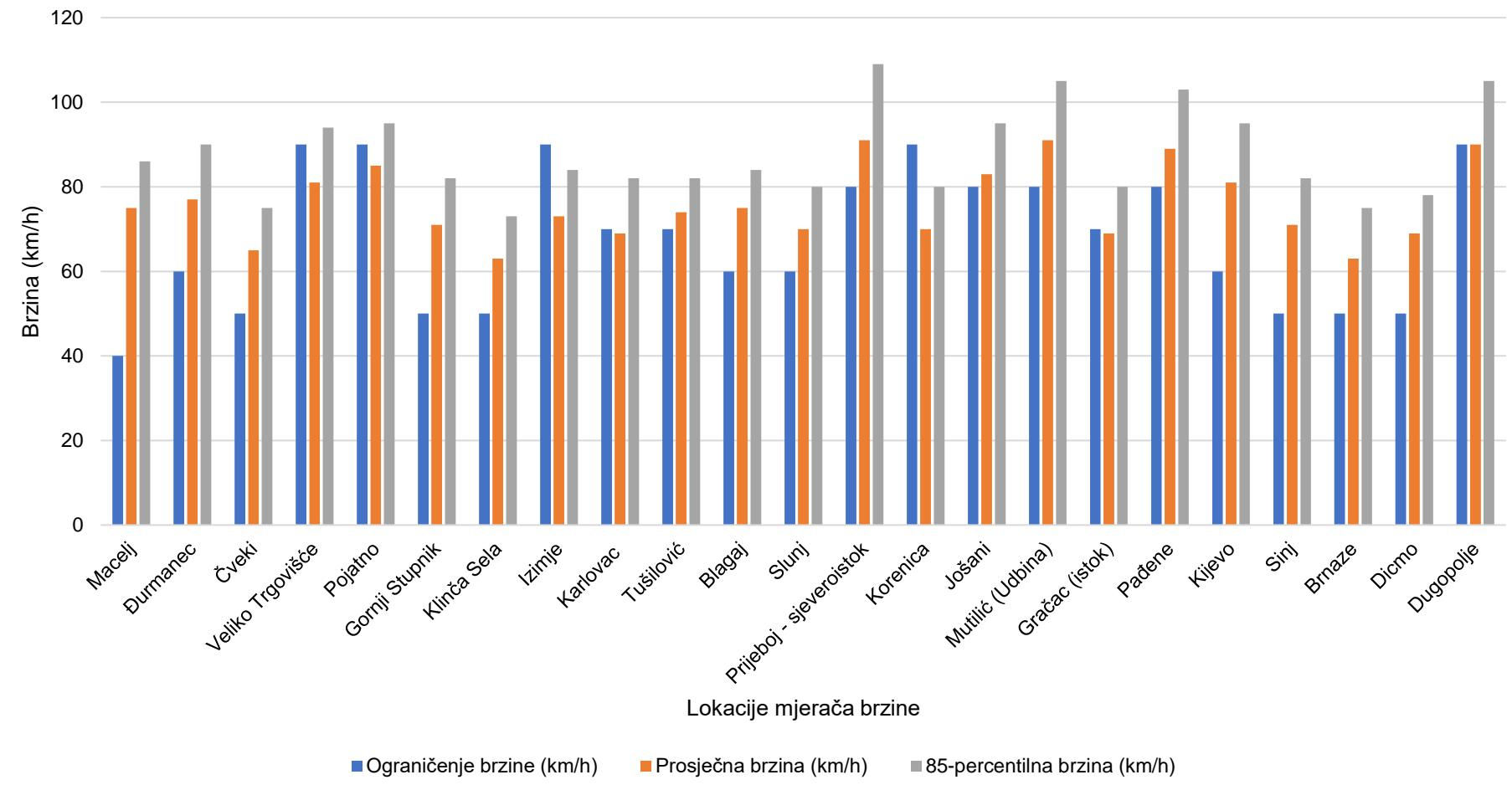
Grafikon 12. Vrijednosti ograničenja brzina na lokacijama mjerača brzina te izmjerena prosječna i 85-percentilna brzina vožnje
