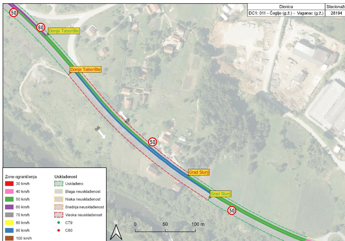
Slika 4. Primjer neusklađenih ograničenja brzine - lokacija 4
