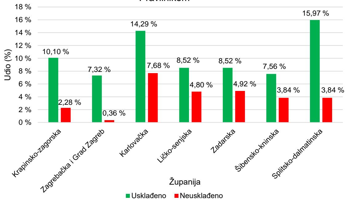
**Grafikon 21. Postotni udio usklađenosti ograničenja brzine u zavojima na državnoj cesti DC1 s projektnim brzinama propisanim Pravilnikom**
