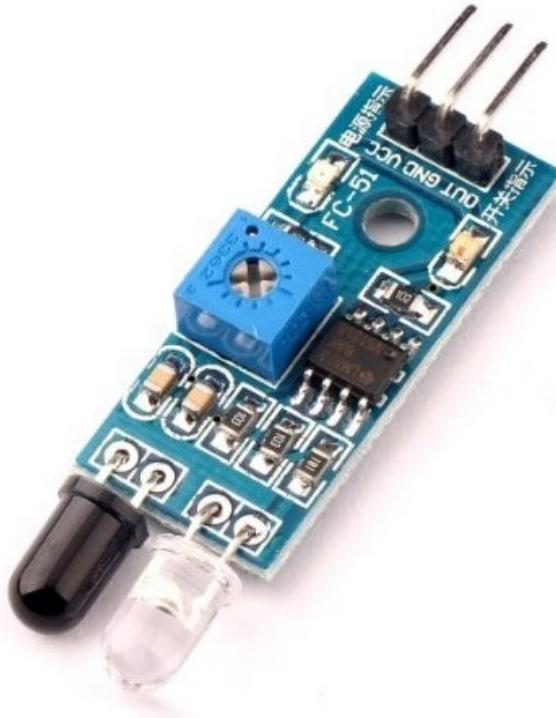
Slika 11: Infracrveni senzor za izbjegavanje objekata KY-032
