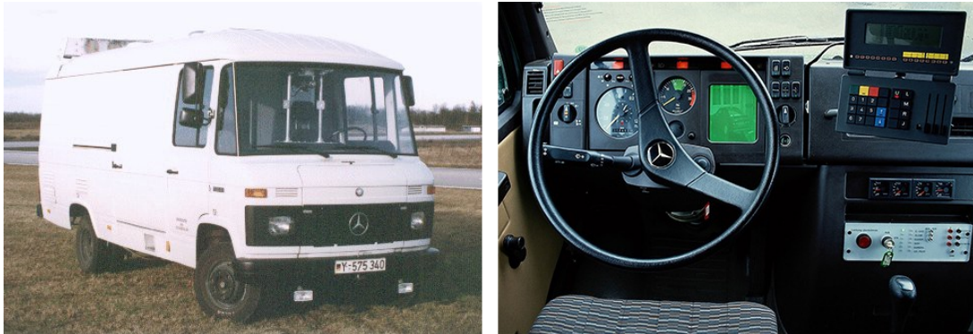
Slika 1: Kombi marke Mercedes-Benz redizajniran kao autonomno vozilo od strane tima Ernst Dickmann-a
